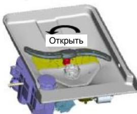
Шаг 1: Поверните ручку фильтра в направлении против часовой стрелки
